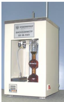
Рисунок 1.13 – Вискозиметр – прибор для измерения вязкости
