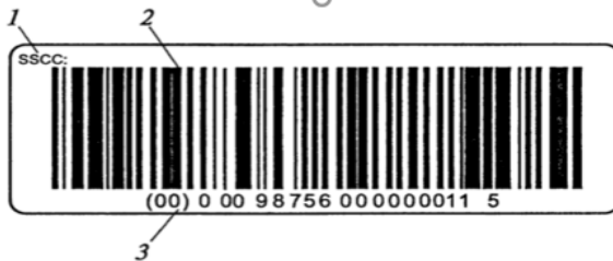
Рисунок 1.37. Основная этикетка EAN/UCC 128: 1 – заголовок штрих-кода; 2 – уникальный идентификатор транспортируемой единицы; 3 – визуальное представление штрих-кода
