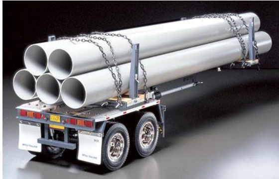
Рисунок 2.25 – Пример укладки и крепления труб.
