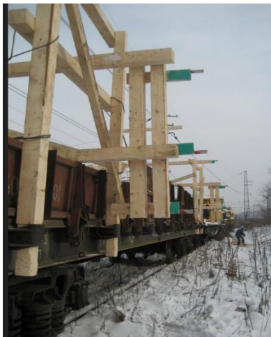
Рисунок 8.7 – Вид контрольной рамы при организации движения негабаритного.
