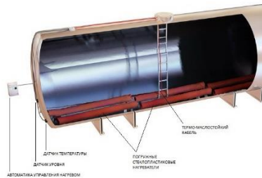
Рисунок 3.7 – Цистерны с тепловой защитой и «паровой рубашкой» для перевозки нефтепродуктов
