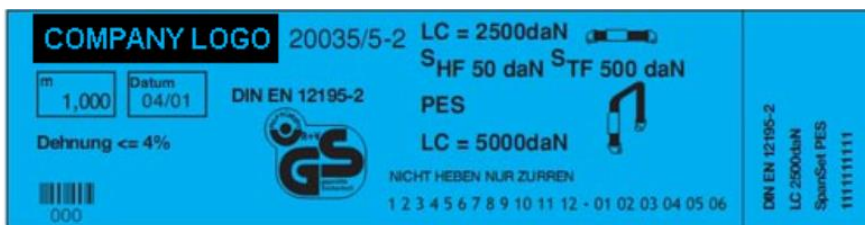
Рисунок 7.9 – Примеры маркировки на натяжных ремнях (допустимая рабочая нагрузка (LC) в daN; стандартная ручная сила ( S_{HF} ); сила предварительного натяжения ( S_{TF} ) в натяжном рычаге в daN, при креплении прижимом)
