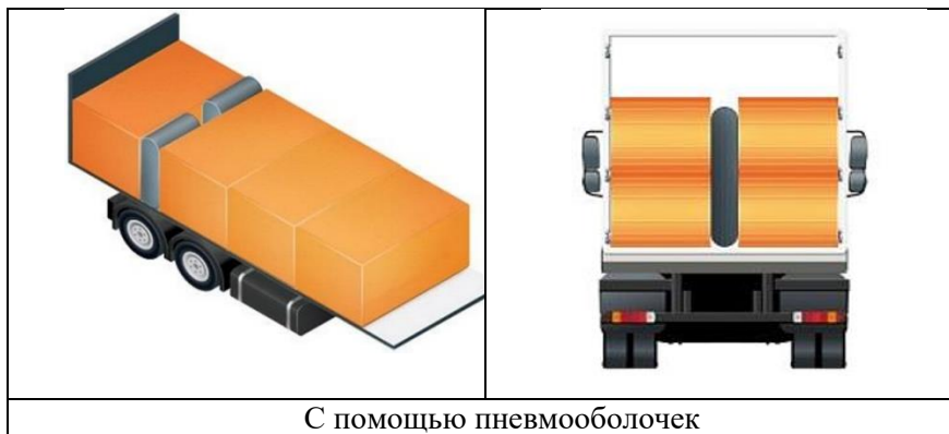
Рисунок 7.6 – Примеры крепления блокировкой
